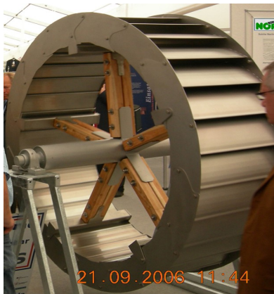
Abb. 23: Segmentkranz-Wasserrad (Quelle: Hartmut Drews)
